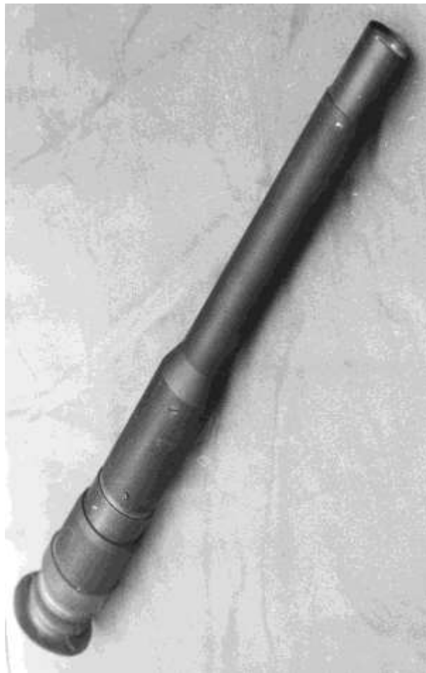
Фиг. 2. Оптична система на “Визир – прицел 15 К” Фиг. 3. Визир - прицел 15 К
