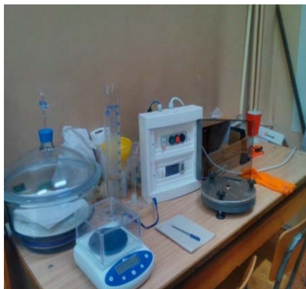
Фигура 1 Схема и фото на CST- апаратура
